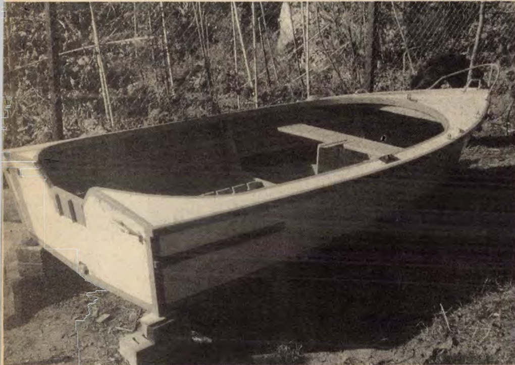
1. A motor „igényeinek” megfelelően erősebb és alacsonyabb lett a fartükör
