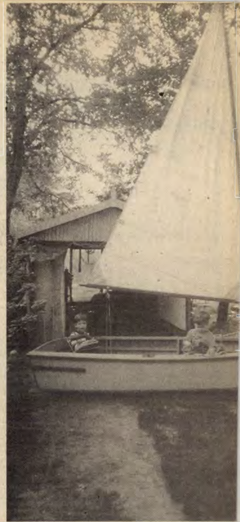
2. Próbaképpen felvont vitorlák. Az úrbocot merevítő kötélet tartja
